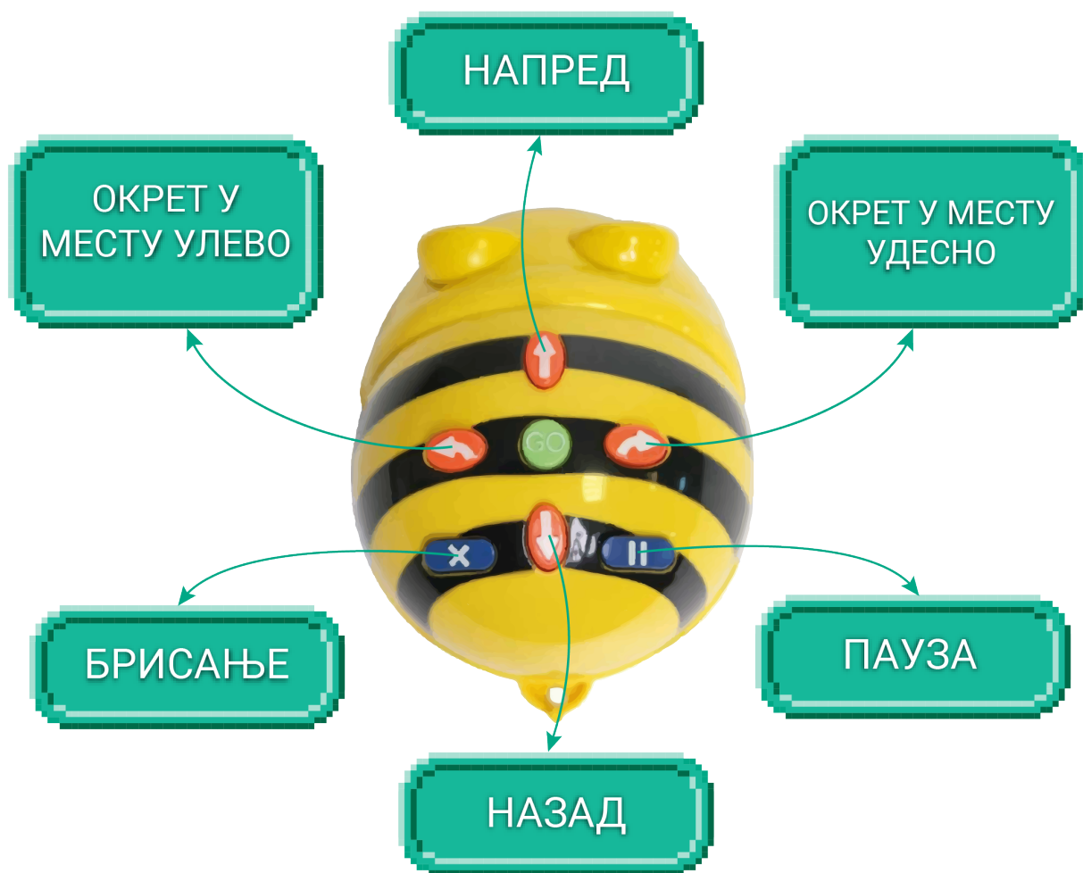
Слика 4: Функције дугмади на Пчелици роботу
